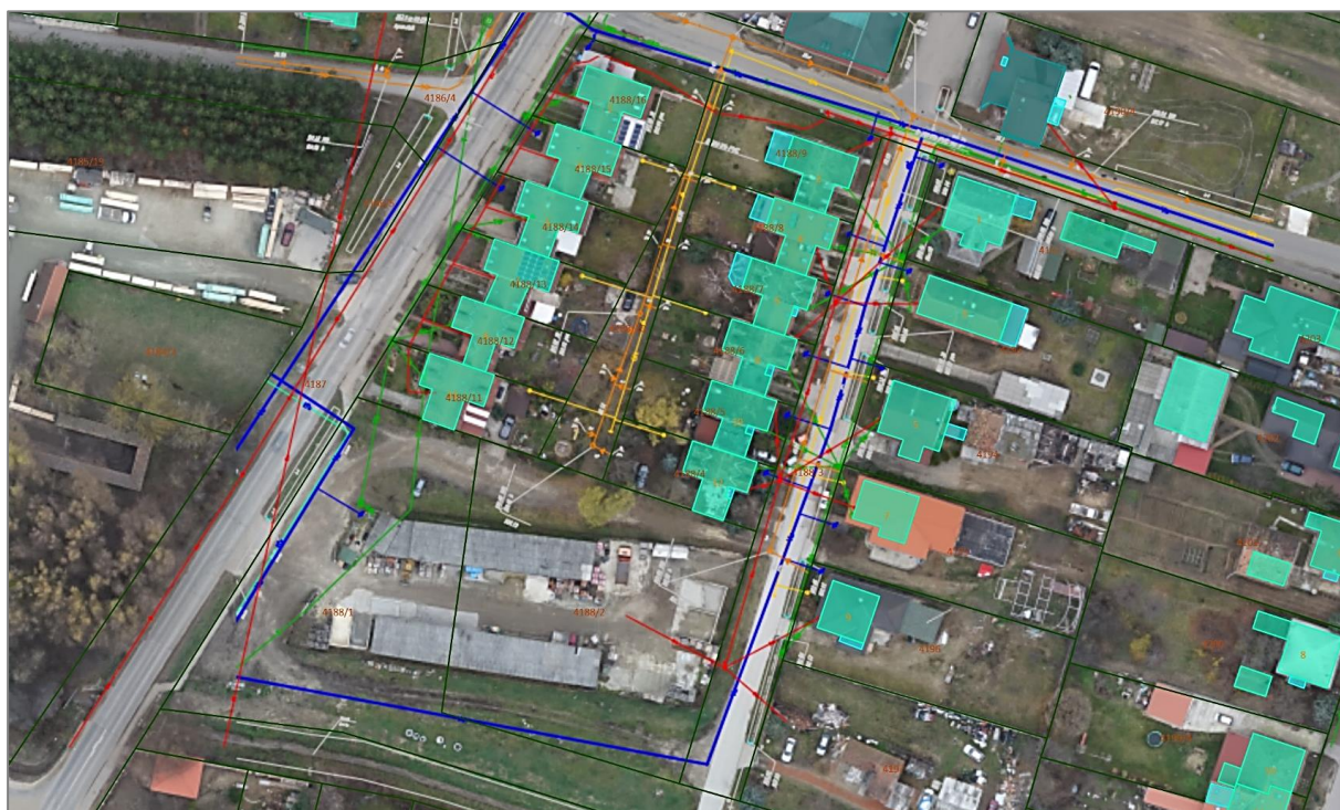
A belső közterületeken halad a szennyvíz-csatorna és a gázvezeték.
