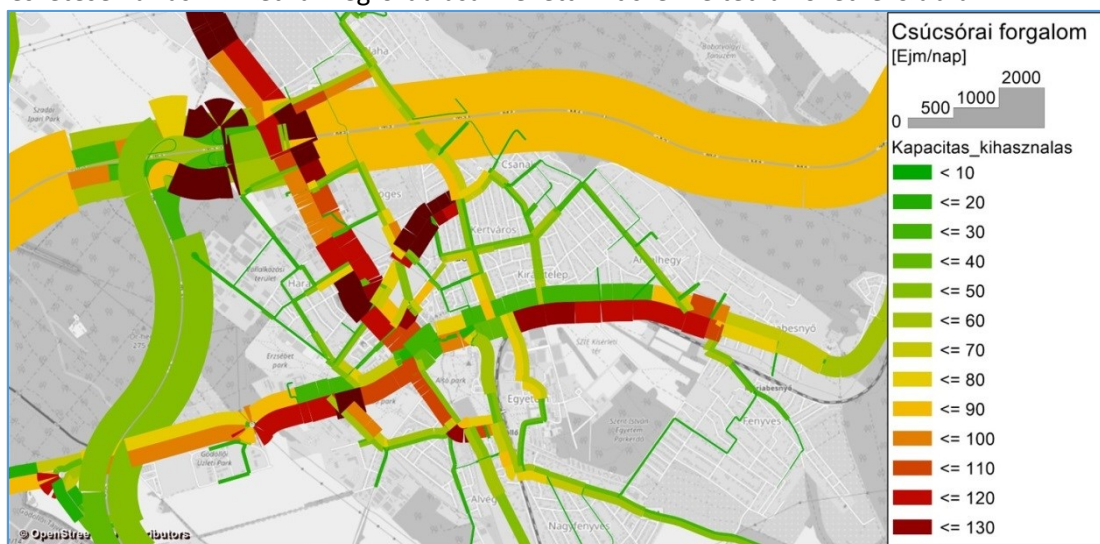
17. ábra, A délutáni csúcsóra kapacitáskihasználása
