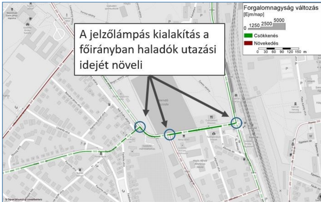
24. ábra, Az Ady Endre sétány nyomvonalán kialakítandó csomópontok hatása a jelenlegi forgalmi igények mellett
