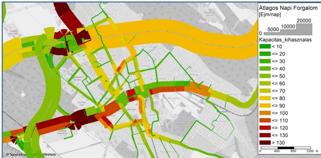
67. ábra, Az 1. ütem fejlesztéseit figyelembe vevő hálózat kapacitáskihasználása a 2029.év prognosztizál forgalmi mellett.
