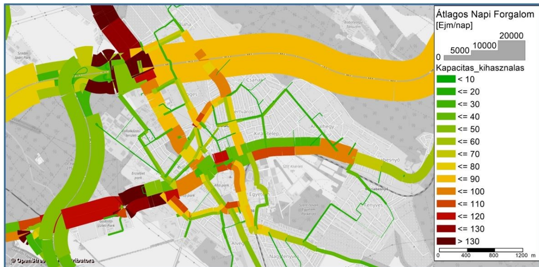
65. ábra, A fejlesztés nélküli hálózat kapacitáskihasználása a 2029.év prognosztizál forgalmi mellett.
