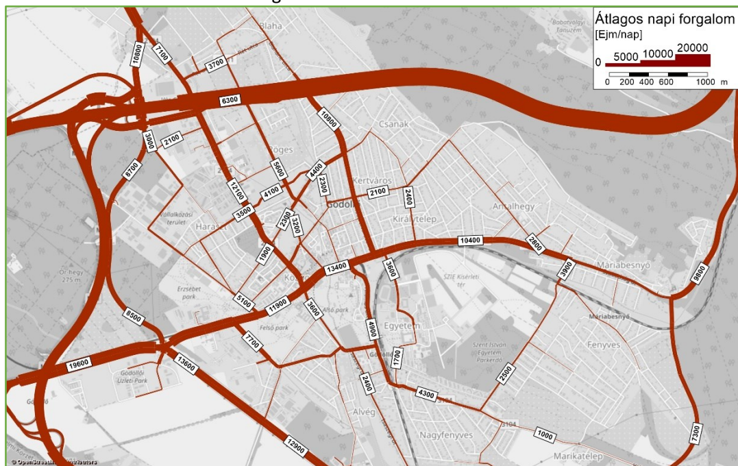
57. ábra, a 2029. év forgalmi terhelése a 2. ütem fejlesztéseinek megvalósulása esetén
