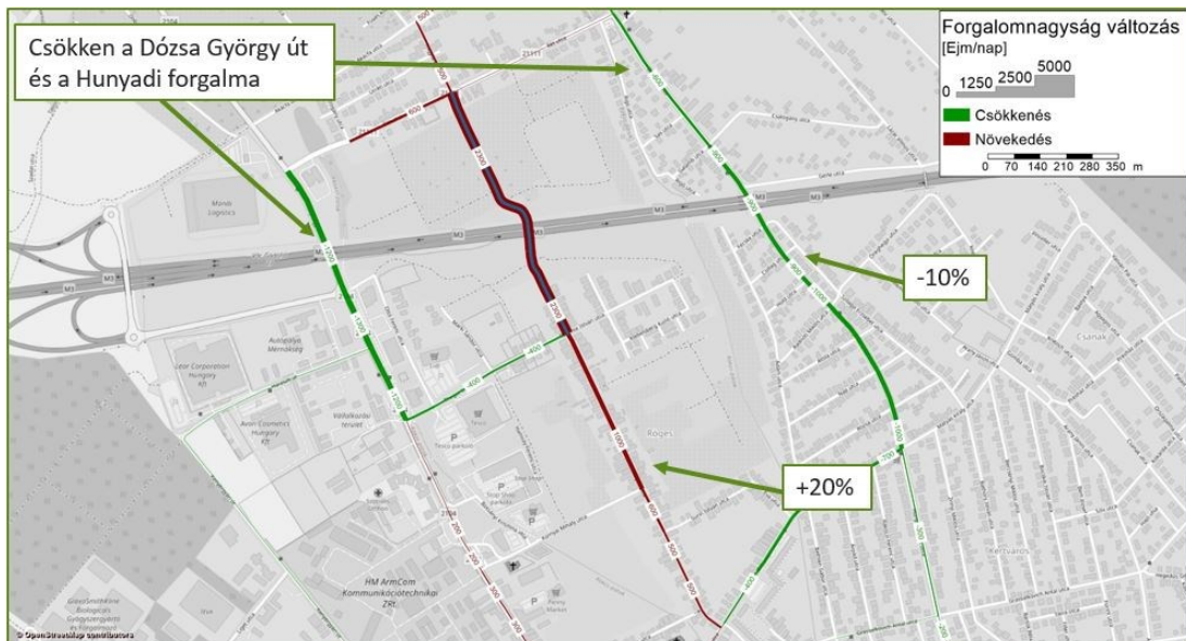
49. ábra, A Röges utcai átkötés hatása a forgalmi áramlatokra
