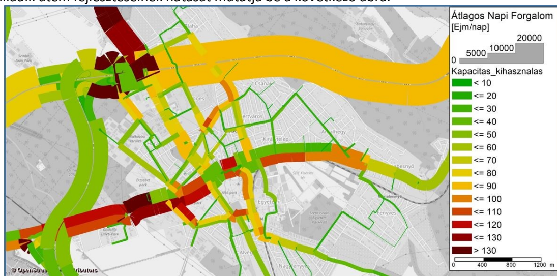
66. ábra, A 0. ütem fejlesztéseit figyelembe vevő hálózat kapacitáskihasználása a 2029.év prognosztizál forgalmi mellett.
