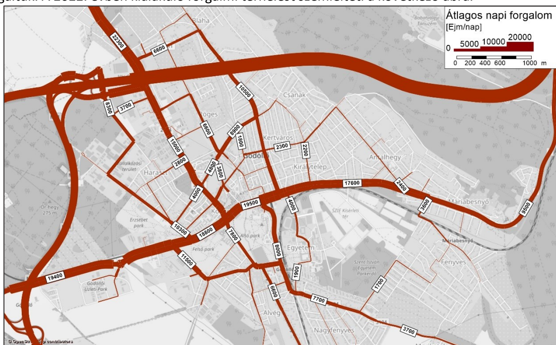
29. ábra, a 2022. év forgalmi terhelése a 0. ütem fejlesztéseinek megvalósulása esetén
